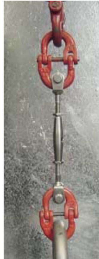
Detailaufnahme: Prüfung von Wantenspannern
