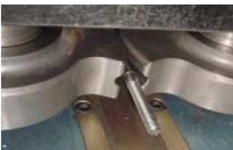
Bitte beachten Sie, dass unsere Terminals nur mit Pressen oder Walzmaschinen montiert werden können. Preßzangen sind hierfür ungeeignet.
