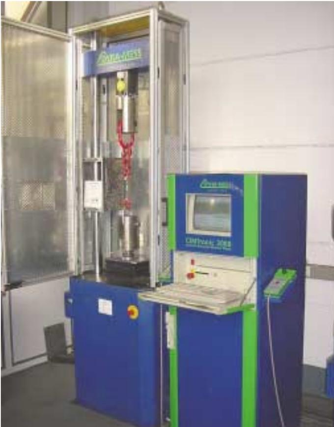
Qualitätsprüfungen mit modernen, staatlich überwachten Zugprüfmaschinen stellen die Produktqualität sicher.
